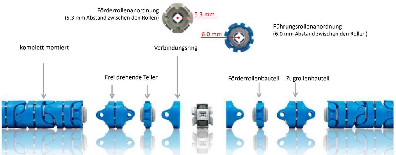
Jede Einheit ist in zwei Achsen beweglich. Hierdurch wird torsionsbedingte Reibung abgebaut. Die Vorschubkraft bleibt auf einem vorteilhaft niedrigen Niveau.
