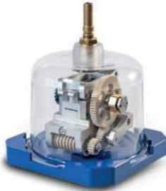
Der Twister kompensiert sanft und zuverlässig die Torsion des Drahtes mit einer gezielten Gegenwirkung. Die sorgfältig aufeinander abgestimmten Komponenten und Zahnräder verhindern jegliche Drahtverwicklungen, Schlingen und Knoten. Über eine Kupplung, die die Förderrollen betätigt, wird der Druck geregelt. Das entlastet den Anwender und spart Zeit.
