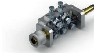
Zur Verwendung bei Drähten aus Aluminium- und Kupferlegierungen. Mit diesem hochwertigen Richtwerk lässt sich die Drahtvorbiegung gezielt einstellen. Es ist bevorzugt vor der Vorschubeinheit zu platzieren und sorgt so für einen gleichmäßigen Drahtverlauf bis hin zur Schweißposition.
